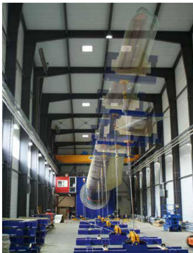
Abbildung 4: Statische Prüfung des AREVA 55.6 m Blatts auf dem Rotorblattprüfstand des Fraunhofer IWES, Quelle: Fraunhofer IWES
